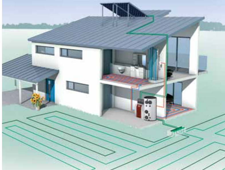
Toplotna črpalčka zemlja /voda z zemeljskim kolektorjem in s sončnimi kolektorji
