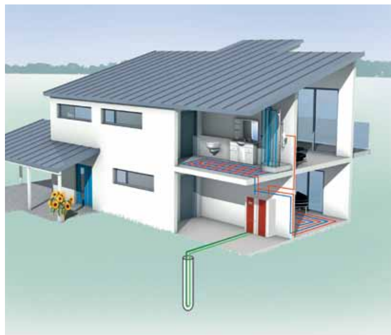
Toplotne črpalke zemlja/voda z zemeljskimi sondami
