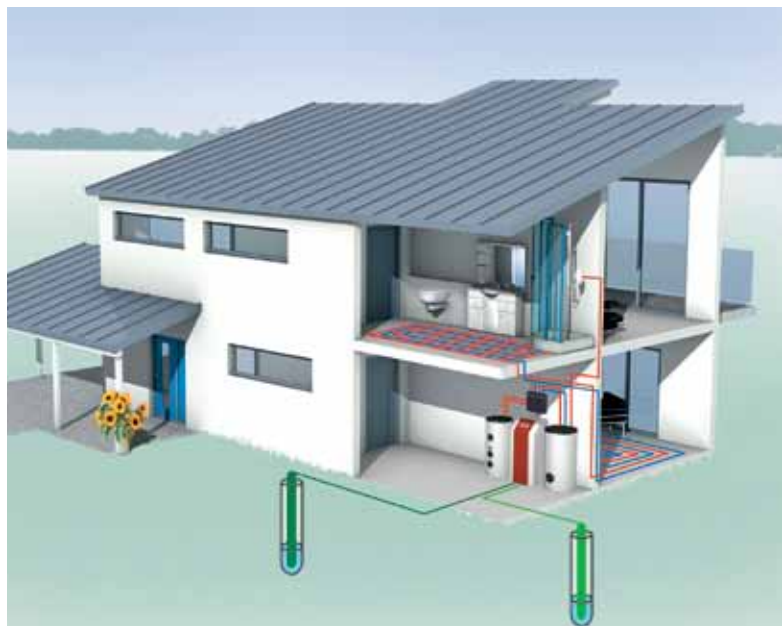
Toplotna črpalka voda/voda z vrtinami
