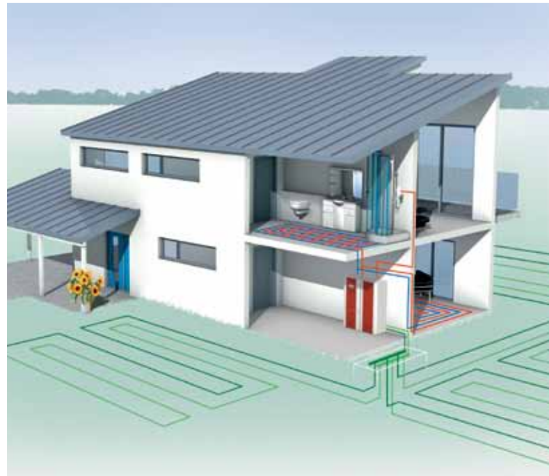
Toplotne črpalke zemlja/voda z zemeljskimi kolektorji
